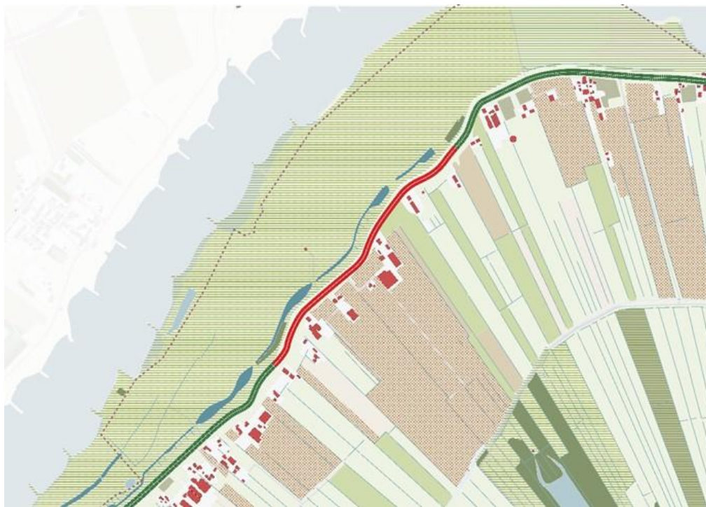
Figuur 3-13 Overzicht van Dijkzone 7 Achthoven-West met in rood het te versterken stuk dijk.
