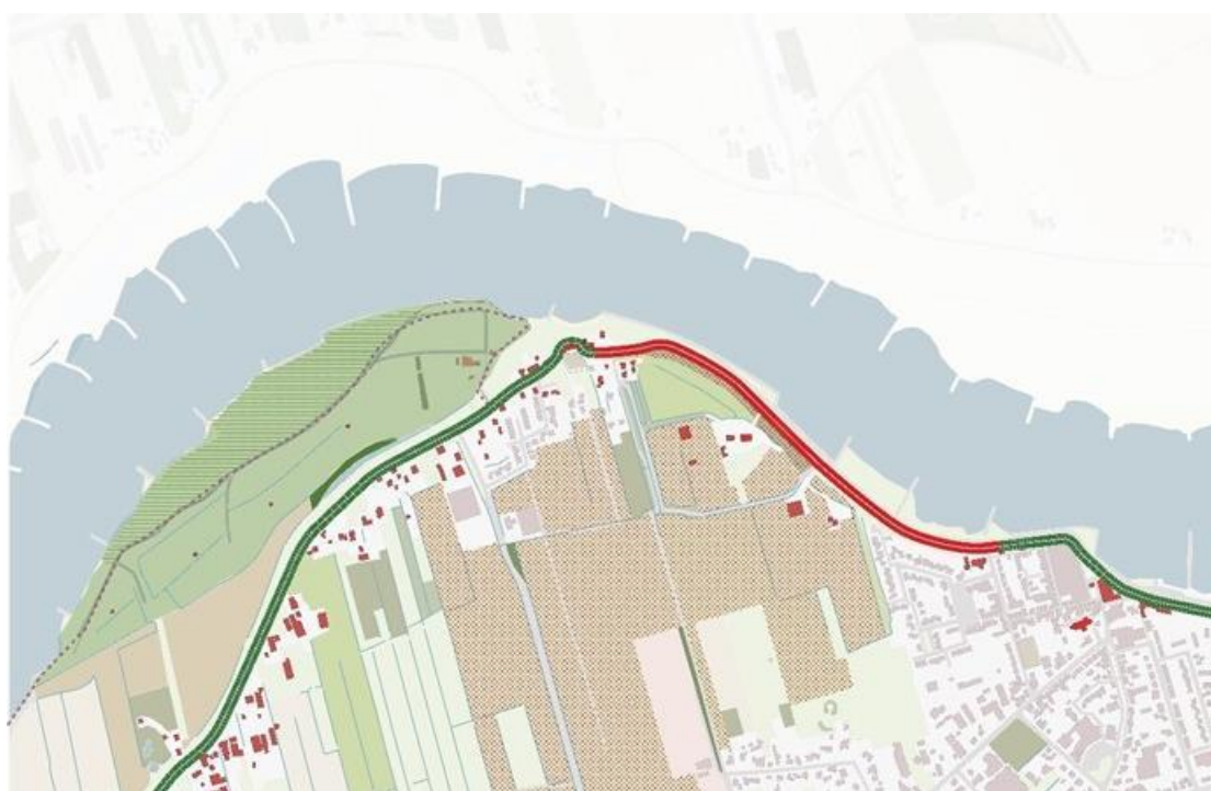
Figuur 3-15 Overzicht van Dijkzone 9 – Tienhoven met in rood het te versterken stuk dijk.
