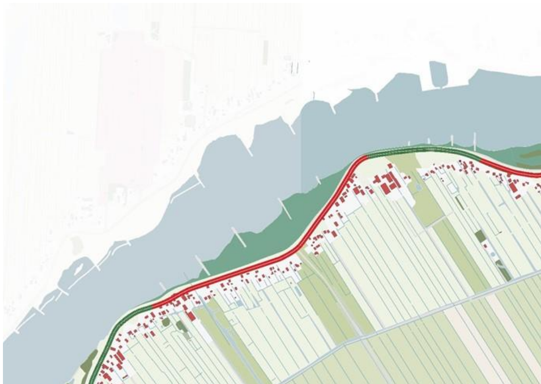
Figuur 3-18 Overzicht westelijk deel Dijkzone 11 - Veer Bergstoep – Streefkerk met in rood het te versterken stuk dijk.
