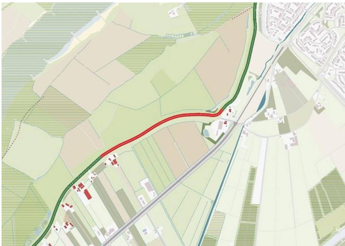
Figuur 3-11 Overzicht van dijkzone 4 Helsdingen met in rood het te versterken stuk dijk.
