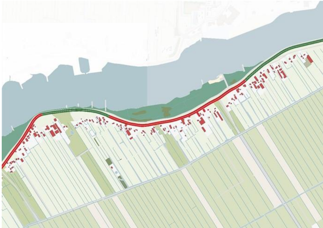
Figuur 3-17 Overzicht oostelijk deel Dijkzone 13 - Veer Bergstoep – Streefkerk met in rood het te versterken stuk dijk.
